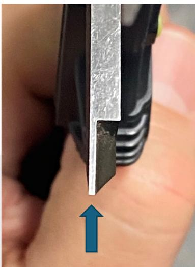
Verificare che la larghezza della parte sottile delle punte del calibro misuri 1 mm o meno (vedere la freccia). Questo è estremamente importante poiché un bordo più spesso porta a una lettura più alta (falsa) dello Squish.
